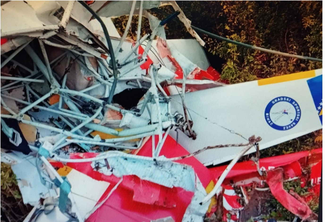
Slika 2. Došlo je do potpunog uništenja kabine i konstrukcije trupa uslijed siline udarca
